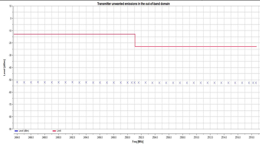
11N20MIMO_Ant2_2412_2400MHz-2BW to 2400MHz
